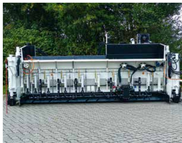
Уплотнительный рабочий орган для мастичного асфальта KBR 75 SSL и т. п. со спредером
