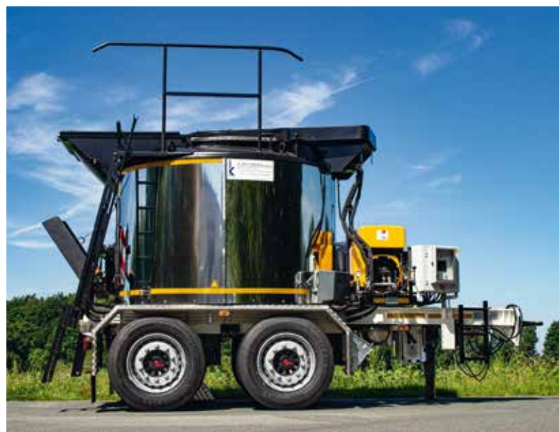
Котел ATK H 12 с глянцевой облицовкой, мазутной горелкой и другим специальным оборудованием
