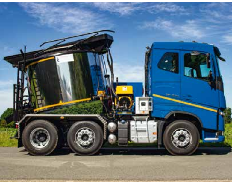
Котел ATK H 12 с глянцевой облицовкой на грузовике, с регулируемым желобом и другим специальным оборудованием
