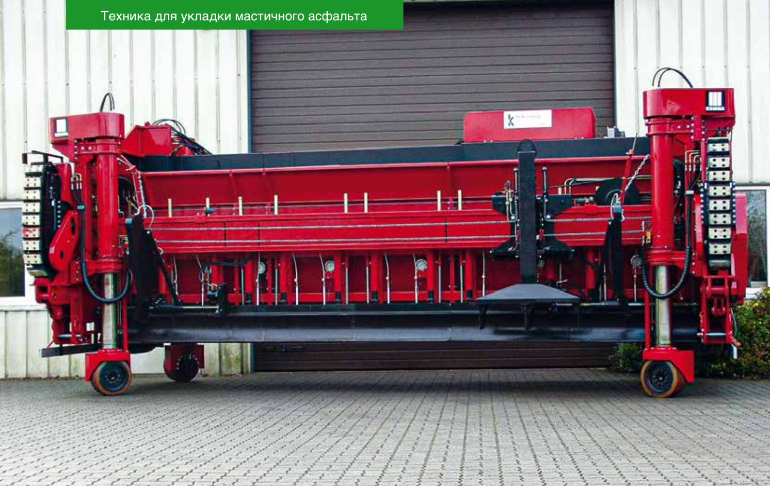
Уплотнительный рабочий орган для мастичного асфальта KBR 75 на выдвинутом колонном шасси, готовый к погрузке
